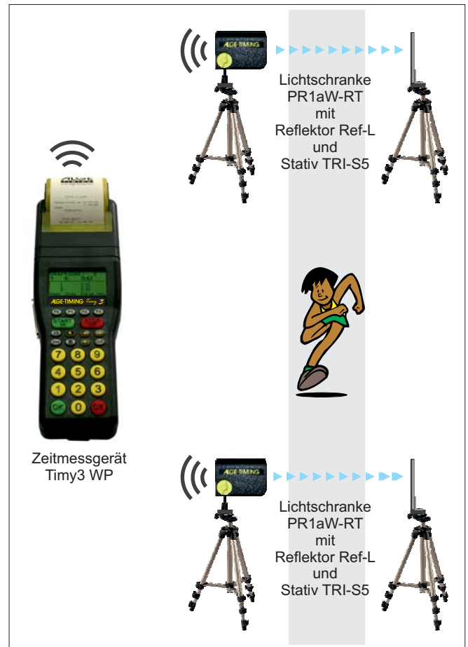
Beispiel des Aufbaus des Systems Training WTN-Set 2
